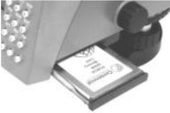
schub und ziehen an der markierten Fläche des Einschubes bis der Rastpunkt überwunden ist und der Einschub sich leicht verschieben läßt. Mit der linken Hand wird das DiNi® leicht festgehalten. Nach dem Erreichen des äußeren Anschlages läßt sich die Karte leicht mit Daumen und Zeigefinger aus der Vertiefung entnehmen. Eine Feder drückt die Karte leicht nach oben.
