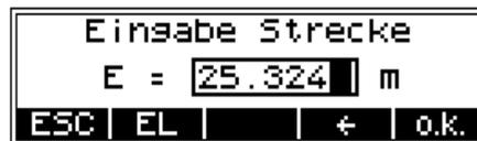
Mit dem Softkey **EL** kann auch die Ablesung am oberen und unteren Reichenbachschen Di-stanzstrich eingegeben werden und das Instru-ment berechnet die Distanz.
