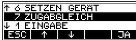
Mit dem Programm "Zugabgleich" werden die auftretende Differenz proportional der Zielweiten auf die einzelnen Lattenstandpunkte verteilt. Als Ergebnis erhält man abgeglichenen Höhen. Die Meßwerte (Lattenablesungen, Strecken) werden dabei nicht verändert. Lattenzwischenblicke erhalten nur die Verbesserung des jeweiligen Instrumentenstandpunktes.
