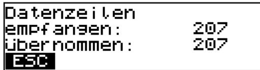
Tip Nach 30 Sekunden ohne Datenverkehr gibt es ein Time Out. Die Meldung „Time Out“ weist auf einen Fehler in den Daten hin. Das Programm geht danach zurück in das Datentransfermenü.
