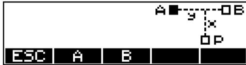
Ist A bestimmt, angemessen oder als Standpunkt festgelegt, wird das Symbol für A (Quadrat) ausgefüllt. Nun können die Punkte B oder P genauso bearbeitet werden.
