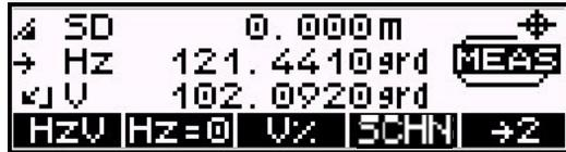
Die Streckenmessung kann mit dem Softkey ESC abgebrochen werden.
