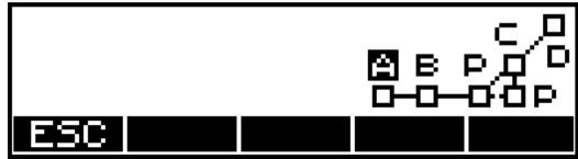
Mit diesem Verfahren kann der Schnittpunkt zweier vertikaler Ebenen bestimmt werden. Die Ebenen schneiden sich in einem beliebigen Winkel.
