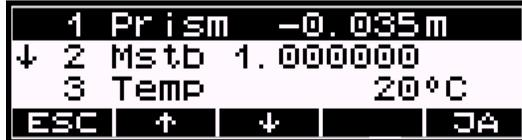
Nutzen Sie dieselbe Methodik zur Eingabe von Temperatur und Luftdruck
