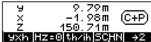
Anzeige mit absoluten Höhen bei eingegebenen Höhe Zs, (und ih. th)
