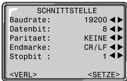
Zur Datenübertragung zwischen PC und Instrument müssen die Kommunikationsparameter der seriellen Schnittstelle RS232 eingestellt werden.
